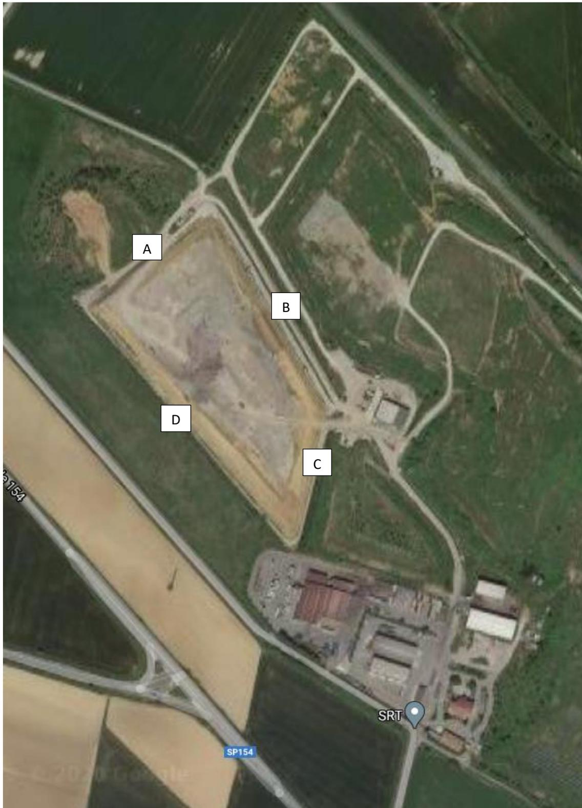
Il monitoraggio mensile di  $\text{CH}_4$ ,  $\text{CO}_2$  e  $\text{O}_2$  nel suolo e nel sottosuolo, sarà indagato nei piezometri 6C, 11, 7 e 6A circostanti il comparto 6, più o meno corrispondenti ai punti A-B-C-D alle profondità di -1, -3 e -5 metri.
